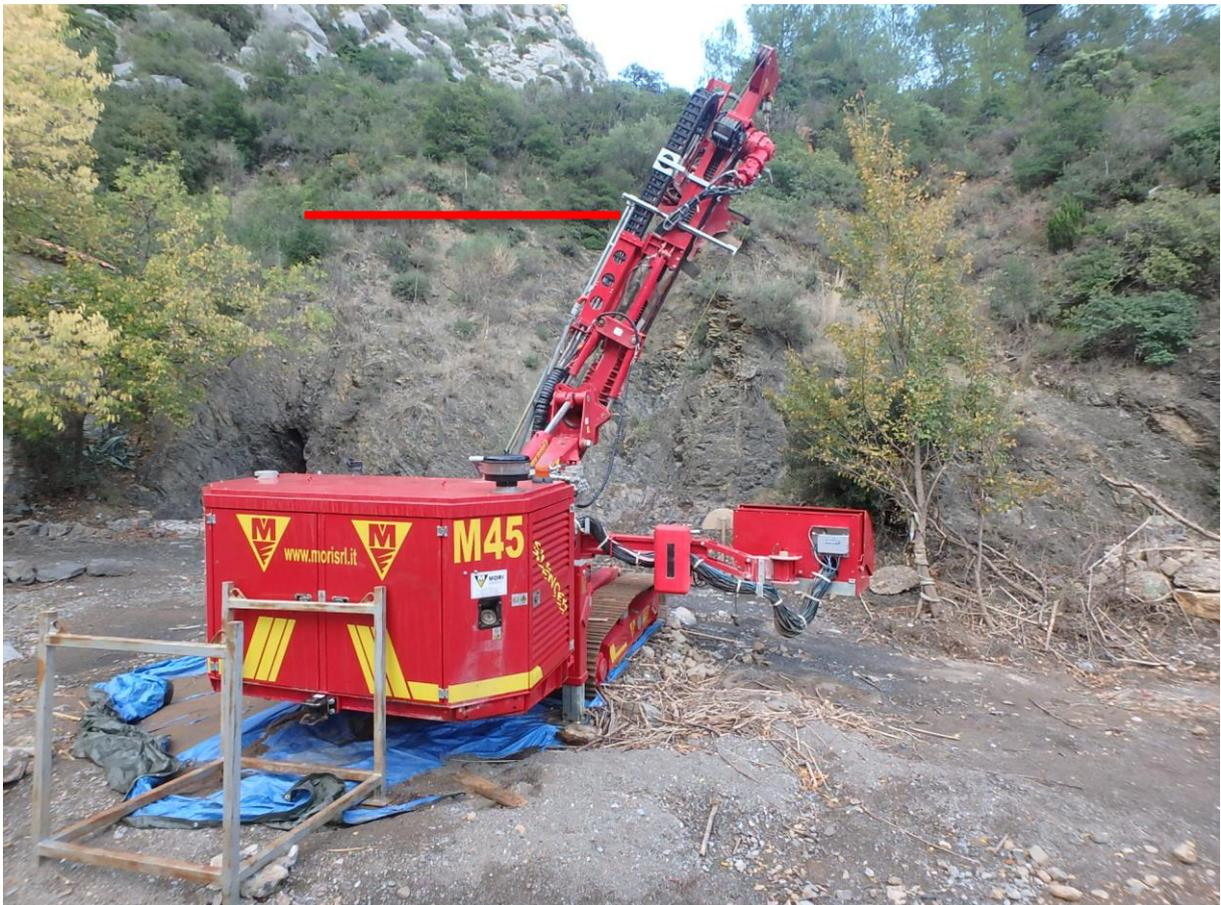
Figure 26: Engin de forage endommagé sur le site des Gouleyrous (hauteur atteinte environ 4 mètres : voir trait rouge)
