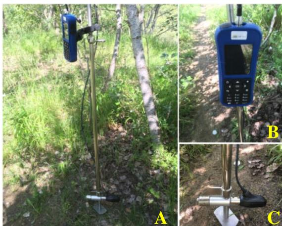
*Figure 12: courantomètre MF-Pro, SMBVA 2018*
