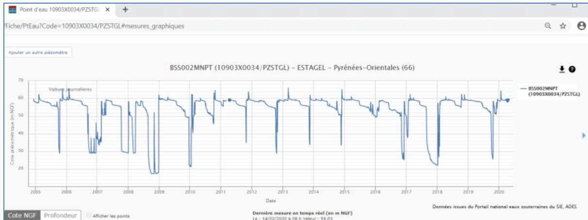
Figure 15: Mesures au niveau du piézomètre d'Estagel au 14 février 2020 (source: BRGM)
